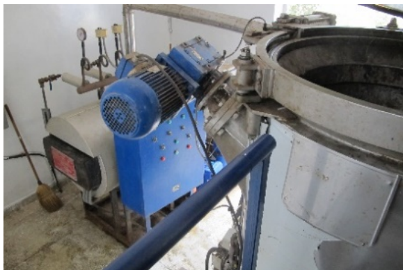
2006年にモロッコ全国21カ所の公立病院に設置された医療廃棄物処理用の破碎滅菌機（フランス製）
