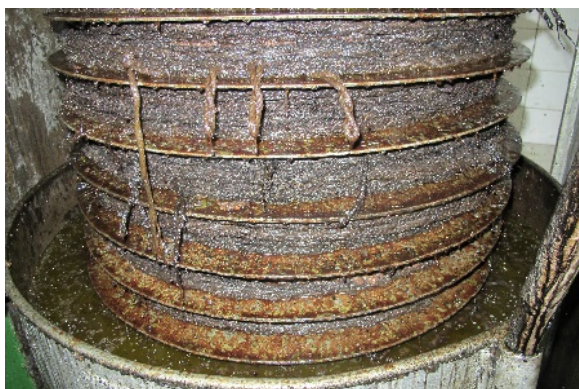
オリーブオイルを製造するための、伝統的なプレス機。圧力をかけて果汁を搾り出す。
