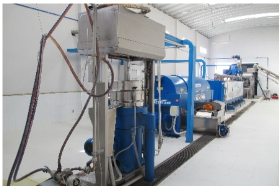
モロッコ政府が導入を進める、搾油果汁廃液（マルジン）の排出量が少ない2相型搾油機
