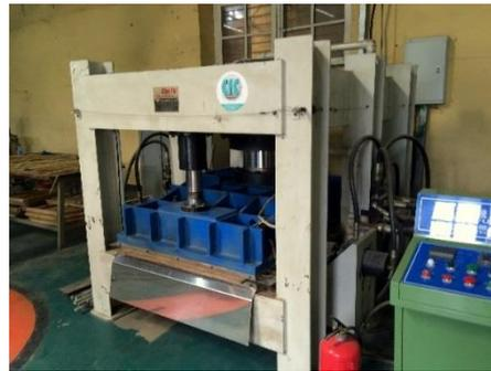
図 2. エチオピアで導入されている圧縮機（竹を集成材に圧縮する機械）
