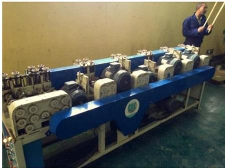
図 1. エチオピアで導入されている竹割り機（竹を細く裁断する機械）
