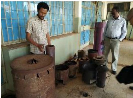
図 5. 現地で開発が進むガス化ストーブ
