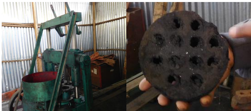
図 3-10. Left:ブリケットマシン. Right:シリンジ状の炭化ブリケット(Beehive Briquet)
