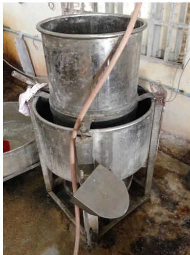
モーターで石臼を回して碎米を水とともに破碎する機械。この技術では米粉のでんぷん損傷が大きく、欧米グルテンフリー市場は狙えない。
