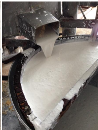
モーターで石臼を回して碎米を水とともに破碎する機械。この技術では米粉のでんぷん損傷が大きく、欧米グルテンフリー市場は狙えない。
