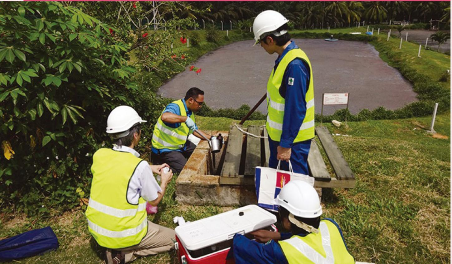
マレーシアで、パームオイル工場における既存の水処理用ラグーン池から水質調査のために採水している阪神動力機械チーム
