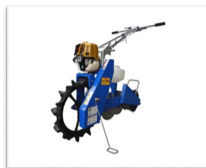
写真2-2-1：自走式大粒播種機 （みのる産業社ホームページより）
