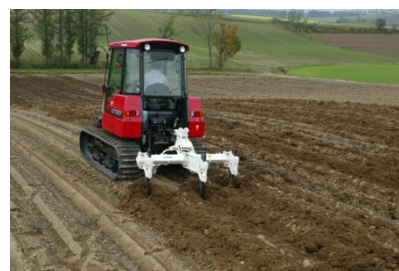
写真2-3-1：プラソイラを使用した作業風景
