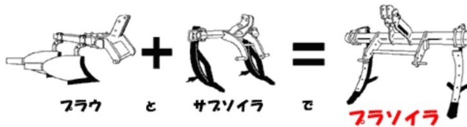
図2-3-1：スガノ農機社ホームページによるプラソイラの図解
