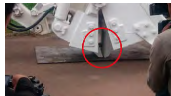
先端部分で挟んで破碎する。爆発することなく、安全に処理が可能。【写真提供：コマツ及びJMAS】
