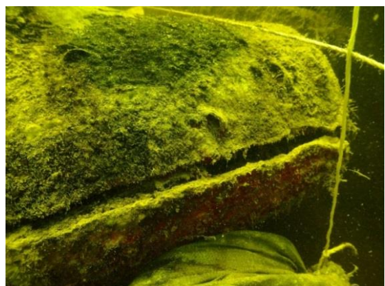
爆雷の表面に見られる亀裂 (亀裂からピクリン酸が漏洩)
