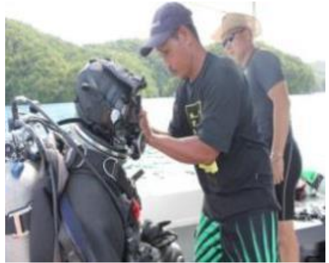
水深 30mの汚染海域での作業に使用する気密性の高い潜水器を着用する専門家
