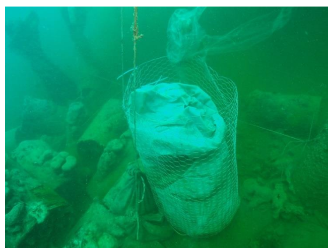
腐食が更に進んでいる爆雷へのビニール・金網利用しての完全密封処置
