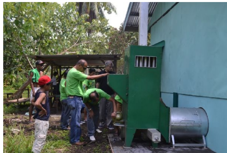
写真 1-4. 倉庫に備え付けられている乾燥機。ココナッツの殻等を燃料に熱風を内部に送り、キャッサバを乾燥させる。
