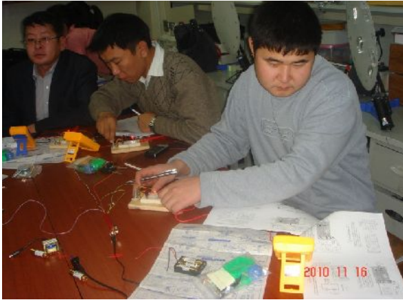
2010/11/16 LEDを点灯し、電圧電流を測定している
