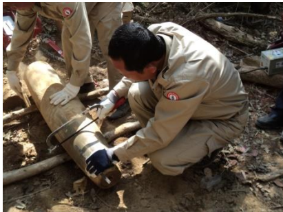
「爆弾のこぎりカット法」試験開始 ①金鋸で切込みを入れる
