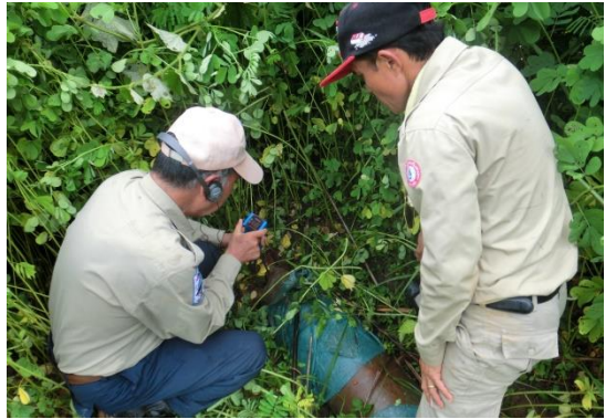
爆弾を電子音聴器で安全確認するJMAS専門家
