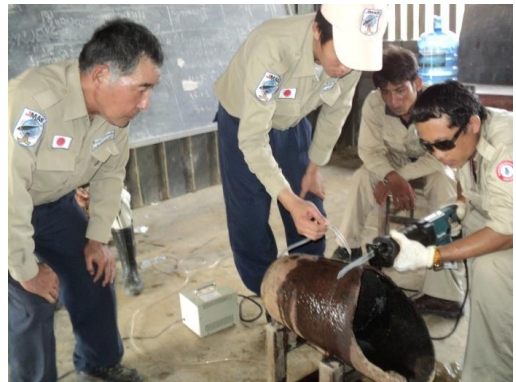
安全化された爆弾(信管なし)を使用して電気ノコギリの使用方法を実習
