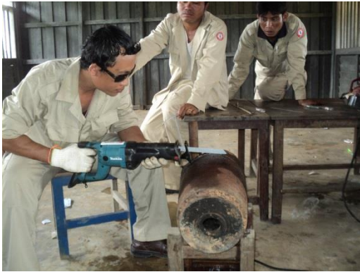
安全化された爆弾(信管なし)を使用して電気ノコギリの使用方法を実習
