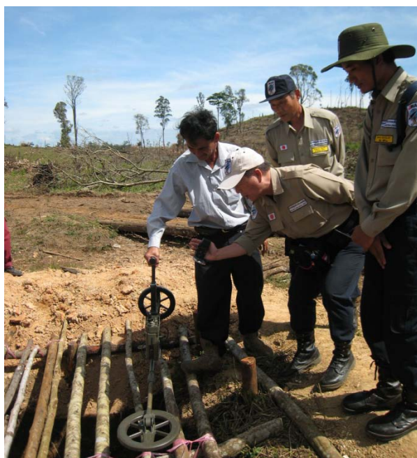
作業開始時には探査機の性能を確認し作業に入ります。JMAS専門家と共に探知機の性能を確認するプロジェクト・コーディネーター
