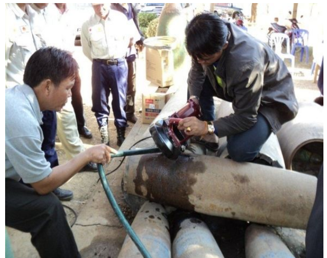
電動金ノコを使用してUXO LaoのSEOD が実習(使用している不発弾は模擬弾)
