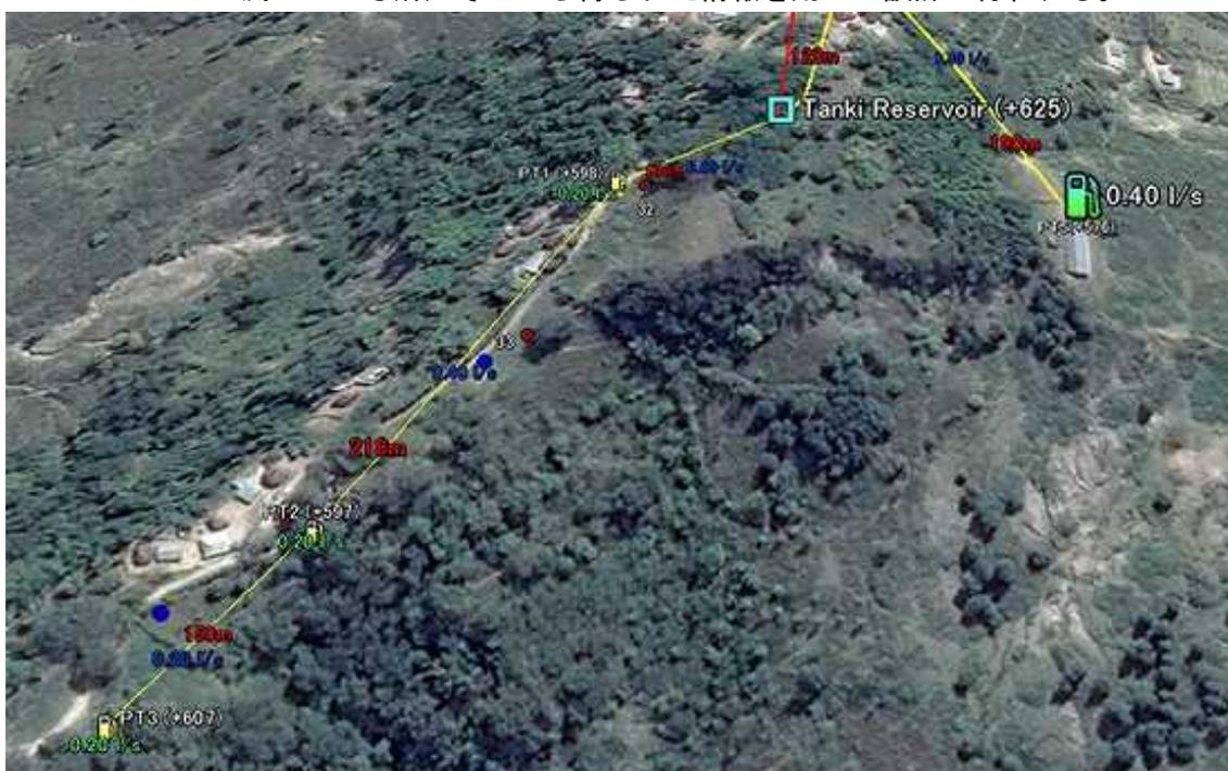
上記の蛇口のGPS座標を用いて設計された水供給システムの一部（写真内のPT2が上の写真の場所）
