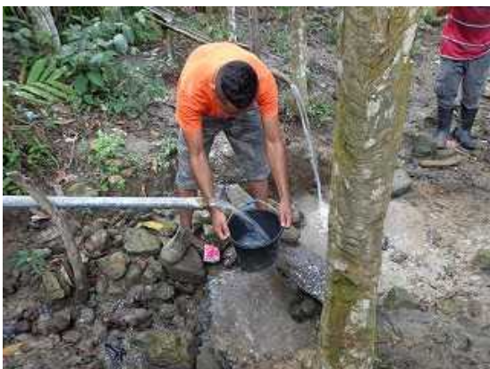
水源における水量の計測の様子
