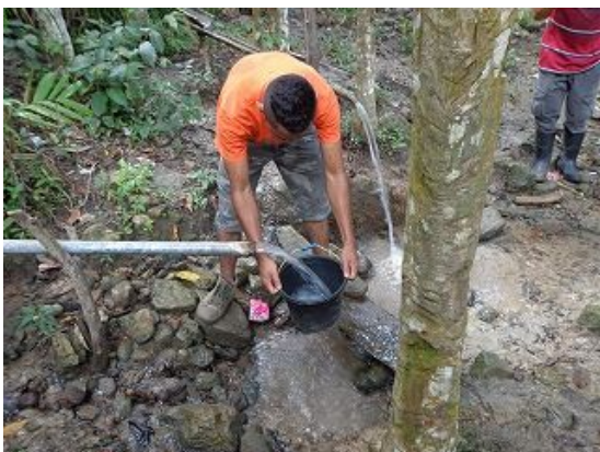
水源における水量の計測の様子
