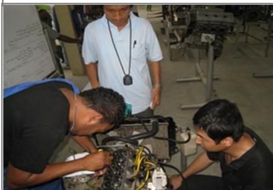
実技能力判定試験風景定期試験： ラジエーターキャップテスト測(上)、 OHVバルブクリアランス調整(下)
