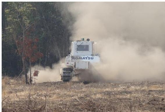
対戦車地雷2段重ねの爆破処理
