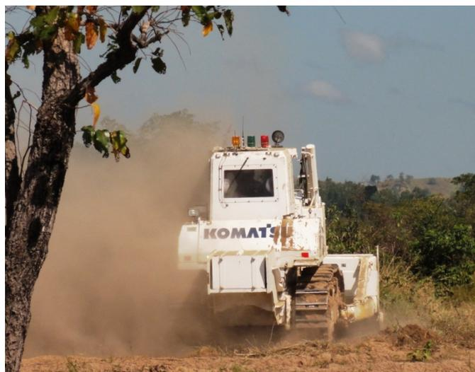
T Sの組織的調査で地雷除去作業を行うDM
