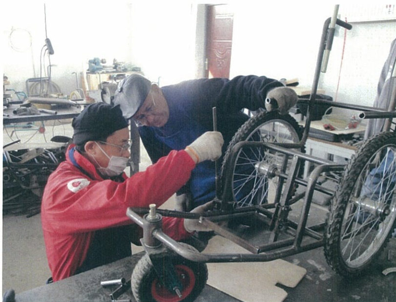
写真5 車いす工房ディルショット職員へ子ども用車いすの製造方法を指導する車いす専門家 (南 廣行氏)(写真左)(2013年1月28日、バクシュ)
