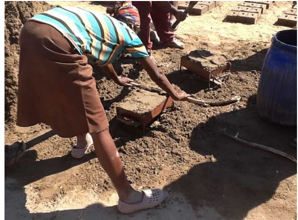
レンガをつくる住民 (2013年7月撮影)
