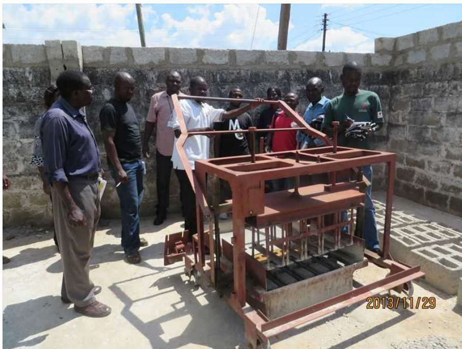
【写真⑥】ルサカ市内ンゴンベ・クリニックで、ブロック造りを通じた所得創出活動の説明を受けるマウントマクル及びナンゴングウェの両クリニック職員及び服薬支援ボランティア。写真は、ブロック製造機械について説明を受けている様子。（2013年11月29日 ルサカ市内ンゴンベ・クリニックにて）
