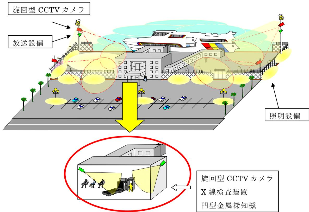
図 旅客ターミナルの機材配置概念図
