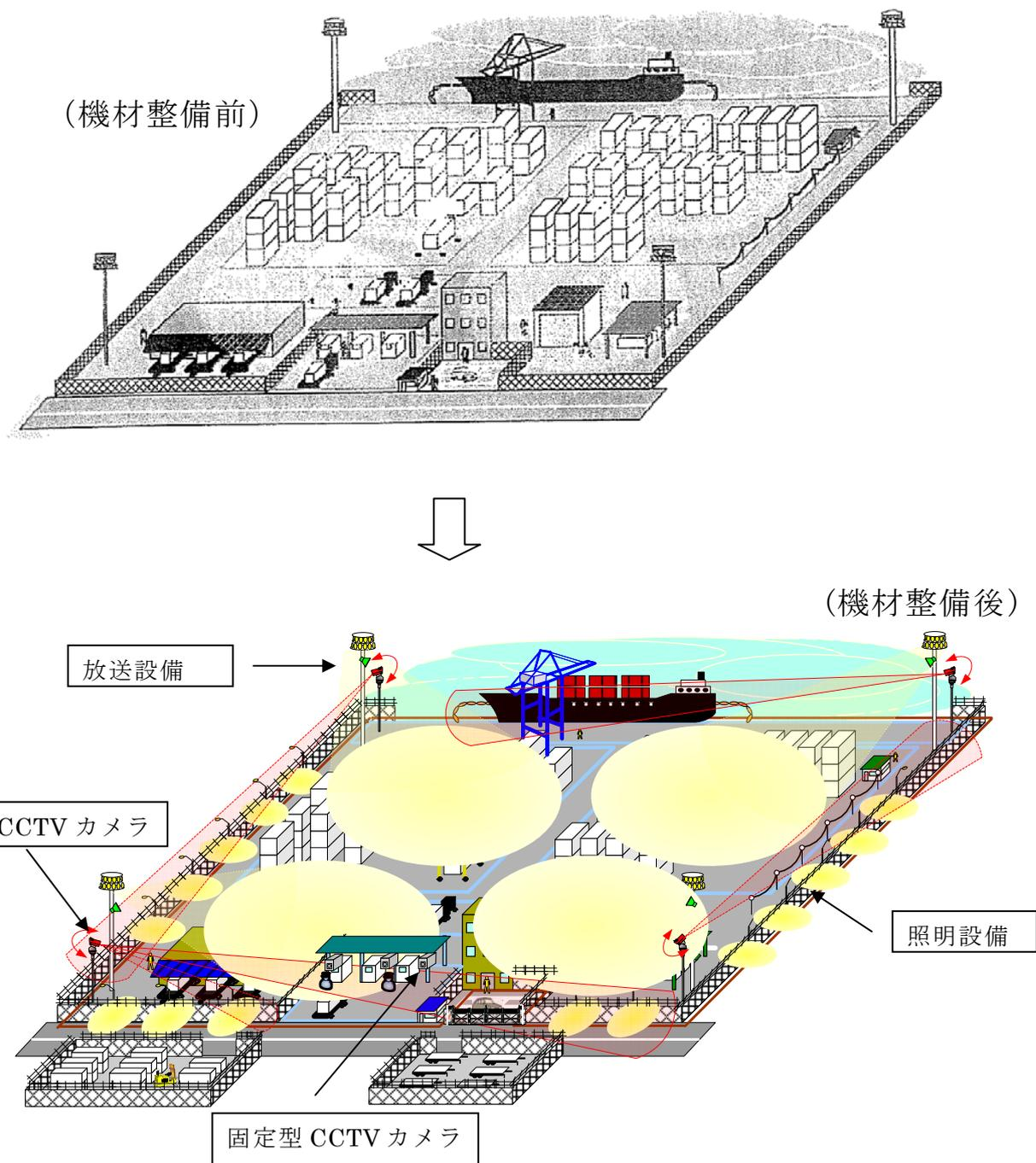
図 コンテナターミナルの機材配置概念図
