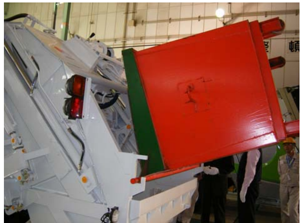
【1期目】8m 3 コンパクタ車 (4) コンテナ反転動作確認 (反転中)
