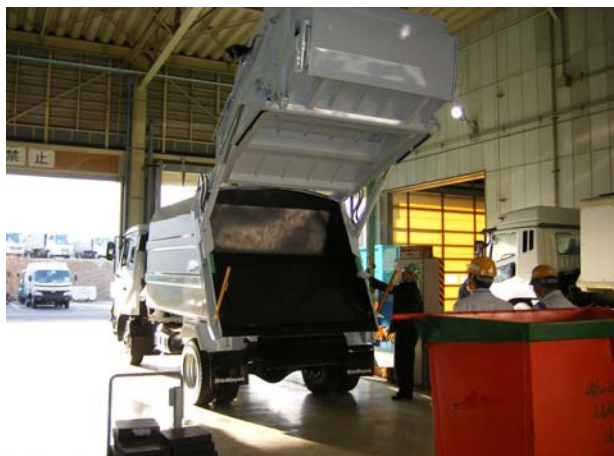
【1期目】8m 3 コンパクタ車 (6) ごみ排出動作確認
