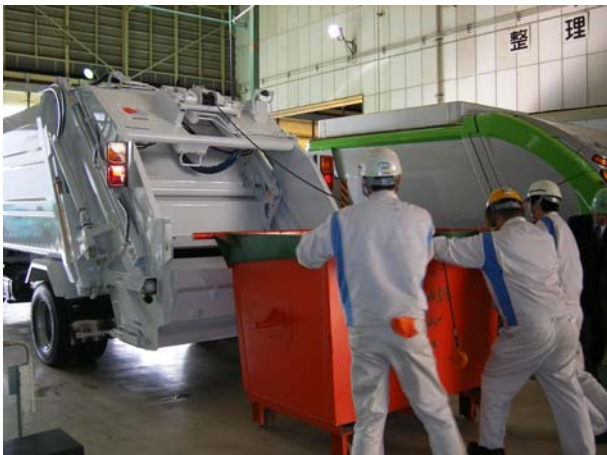
【1期目】8m 3 コンパクタ車 (3) コンテナ反転動作確認 (開始前)
