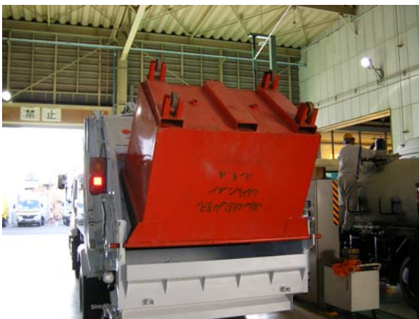
【1期目】8m 3 コンパクタ車 (5) コンテナ反転動作確認 (反転終了)
