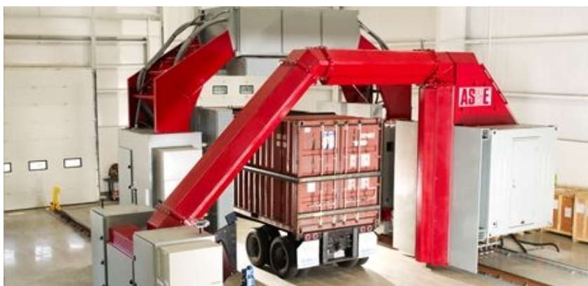
大型 X 線検査装置（移設可能式）（イメージ）
