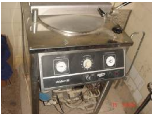
縦型滅菌器(マッサワ病院) 調達年不明、故障中、容量約 5 0 L
