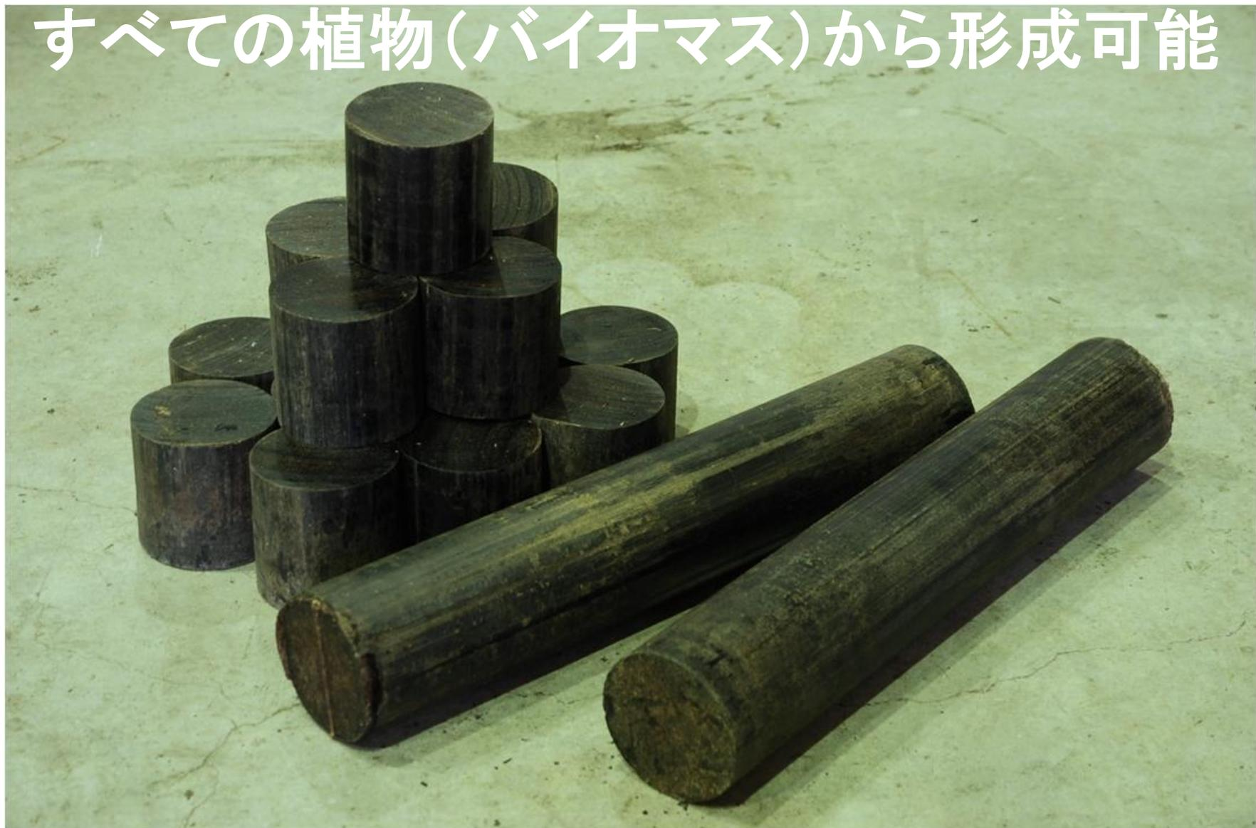
直径10cm 加熱温度180°C-20分, 加圧力20MPa
