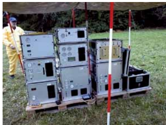
現地査察の野外演習で使用された放射性核種測定装置
