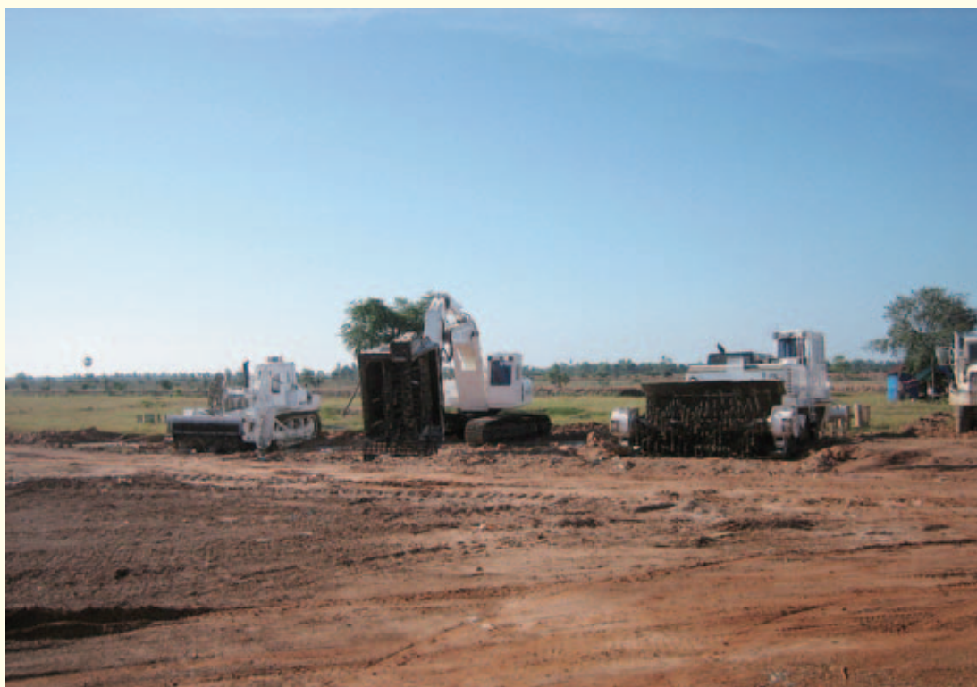
日本の地雷除去機三種（左からコマツ、日立スイングタイプ、日立プッシュタイプ） （提供：JICA）
