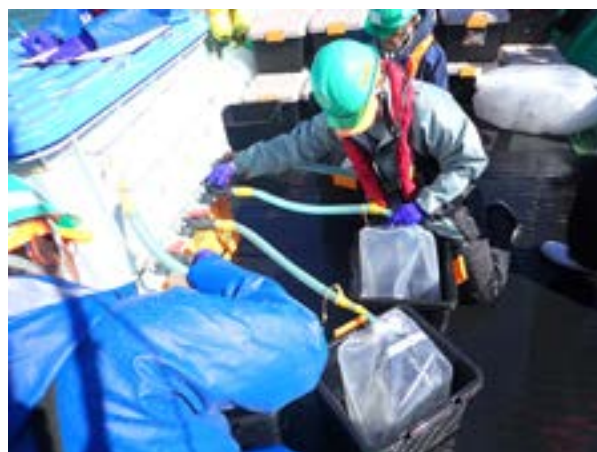
東電福島第一原発沖でH-3分析用の表層海水試料を採取している様子（10月、福島県 写真提供：原子力規制委員会）
