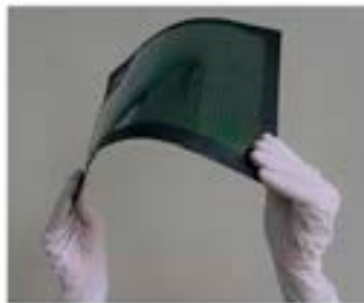
フィルム型ペロブスカイト太陽電池（写真提供：株式会社東芝） （注）この成果は、国立研究開発法人新エネルギー・産業技術総合開発機構（NEDO）の委託業務の結果得られたものです。
