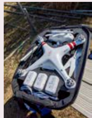
地雷・不発弾などの熱画像取得及び解析を行う実証実験用のドローン
