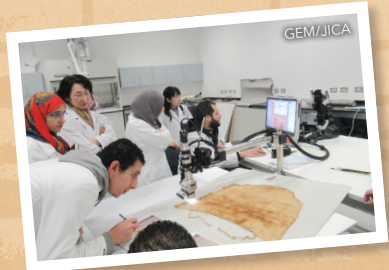
高精度デジタルマイクロスコープ（JICA供与機材）による布繊維の調査
