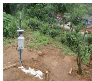
地すべりの前兆を計測するため高台に設置されたばらまき型傾斜計。今日も麓の商店を守っている。
