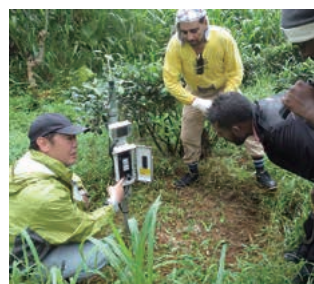
地すべりの前兆を計測するため高台に設置されたばらまき型傾斜計。今日も麓の商店を守っている。
