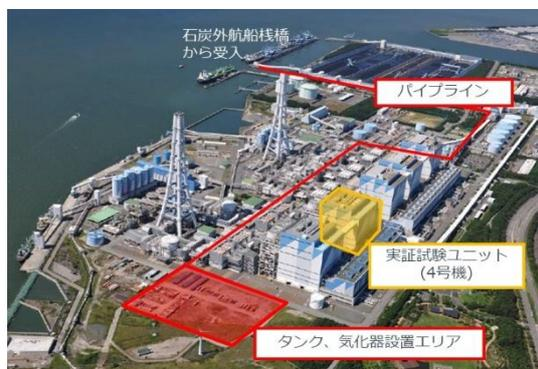
図9 碧南火力発電所におけるアンモニア混焼実証
