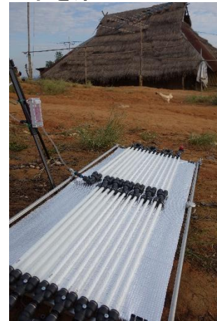
図4 光触媒による飲料 水浄化現地実験
