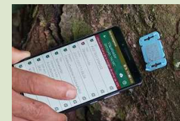
バーコードの読み取りによる木材のトレーサビリティ技術を開発(パナマ)
