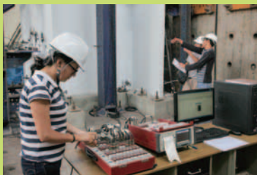
日本の援助で地震・津波減災技術向上プロジェクト が進められているペルーで、地震の揺れによる 壁面ダメージを計測しているところ (写真提供：岡原功祐/JICA)
