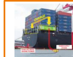
停泊中船舶への 陸上電源供給
