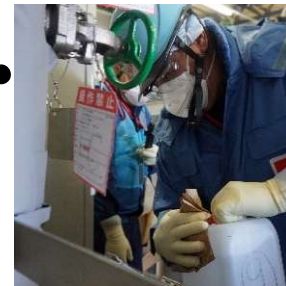
海水希釈前のALPS処理水を採水する専門家（東京電力福島第一原子力発電所構内、2025年2月21日）
