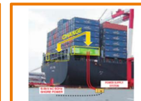
停泊中船舶への 陸上電源供給
