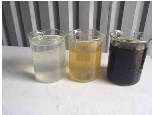
図 2 水処理状況（左：最終処理水、中：一次処理水、右：原水）
