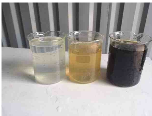
図3-2-2 水処理状況（左：最終処理水、中：一次処理水、右：原水）
