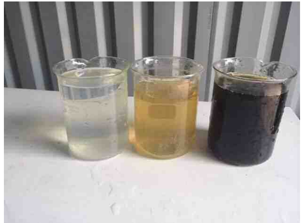
Pic8. 水処理状況 (左：最終処理水、中：一次処理水、右：原水)
