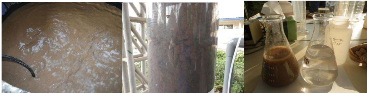
写真 12 高濁度模擬原水(濁度 3,000 度の場合)
