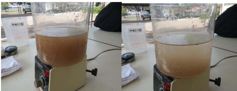
写真 10 PAC 注入率 200mg/L 時のフロック生成状況(左:原水 右:攪拌後)
