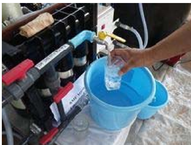
写真 8 SMF 膜ろ過水の採取状況
