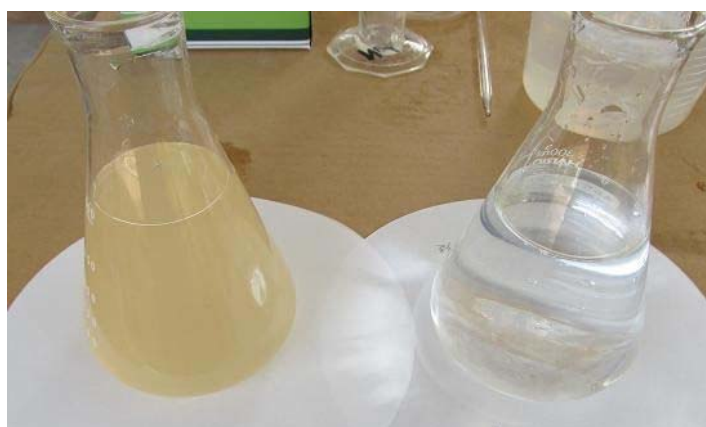
写真 7 通水試験の結果 (左:原水(濁度:67度)、右:処理水(濁度:0.2度))
