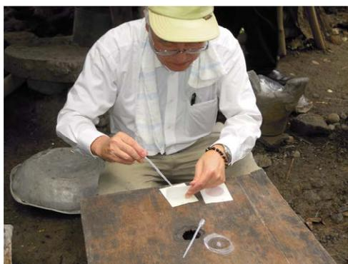
写真3-2：試薬による水質試験
