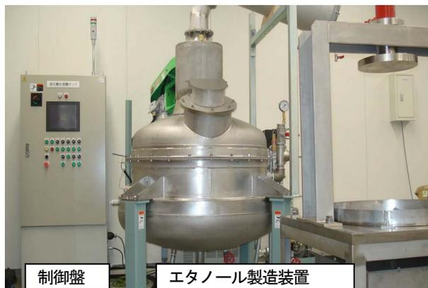
基地を構成する蒸留器、脱水器
