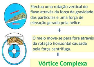
Efectua uma rotação vertical do fluxo através da força de gravidade das partículas e uma força de elevação gerada pela hélice
