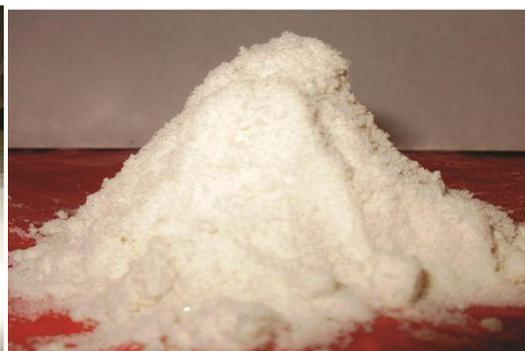
写真) スプレードライヤを用いて製造したココナッツシュガー
