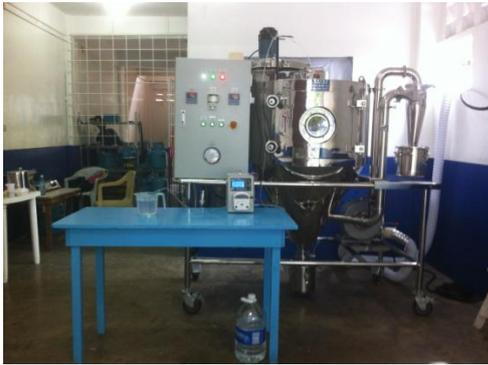
写真) スプレードライヤ全景
