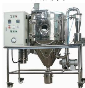
スプレードライヤの基幹部品はアトマイザ（噴霧装置）であり、このアトマイザの回転ディスクには、大川原化工機の特許技術であるM型ディスクが使われている。
