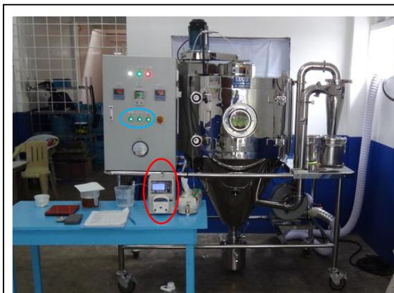
写真) サイトに設置されたスプレードライヤ
