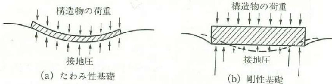
軟弱な地盤において D・BOX はたわみ性基礎であり、コンクリート基礎に比べ均等に接地圧が作用し大きな地盤支持力を確保することが可能である。
