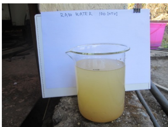
図 3-7 ジャーテスト用のサンプル溶液（濁度 100NTU）
