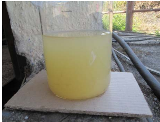
図 3-8 Ferric Alum0.25ml(50ppm)注入後のサンプル溶液（濁度 76NTU）
