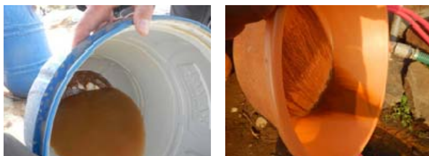
図 3-17 擬似濁水に含まれていたと推察される粒径の大きい砂質
