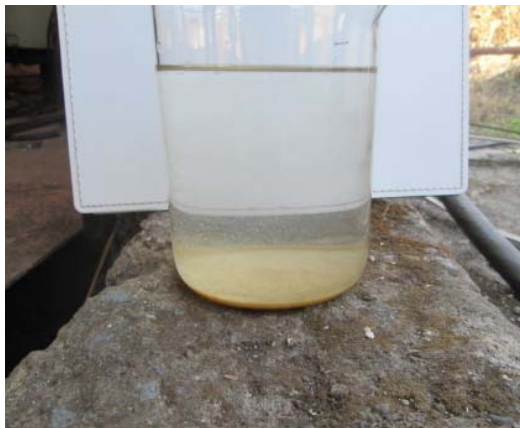
図 3-9 PAC0.1ml(20ppm)注入後のサンプル溶液（濁度 7.8NTU）
