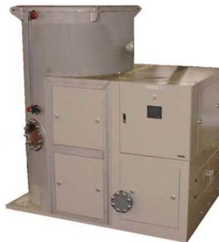
図 2-2 改良型リーチフィルター (RFS シリーズ：円筒型)
